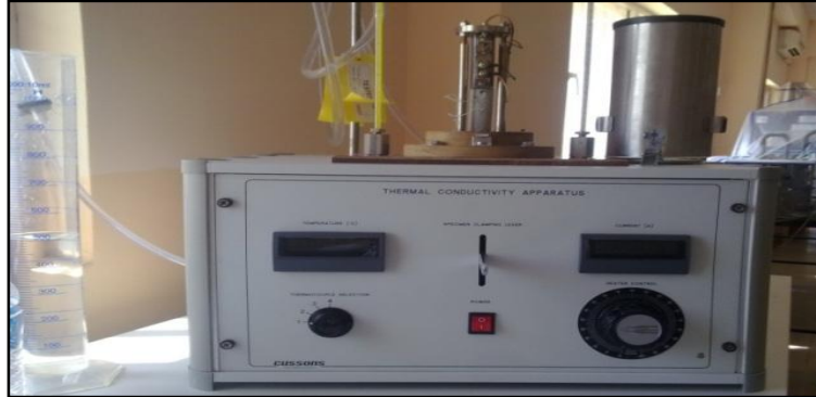
صورة رقم (١) توضح جهاز قياس الموصلية الحرارية المستخدم في هذه الدراسة
