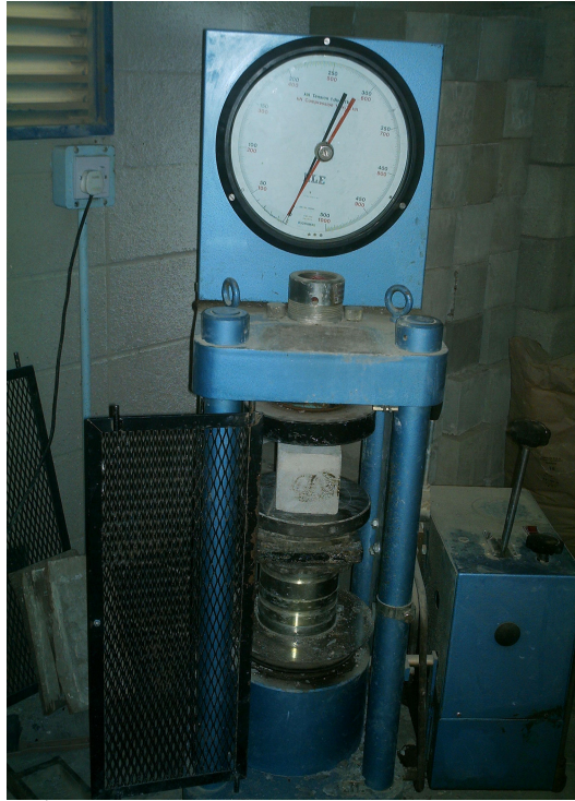
شكل رقم (3) الجهاز المستخدم في فحص مقاومة الأنضغاط.
