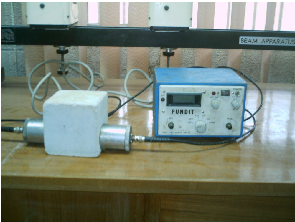
شكل رقم (4) الجهاز المستخدم في فحص سرعة الموجات فوق الصوتية.
