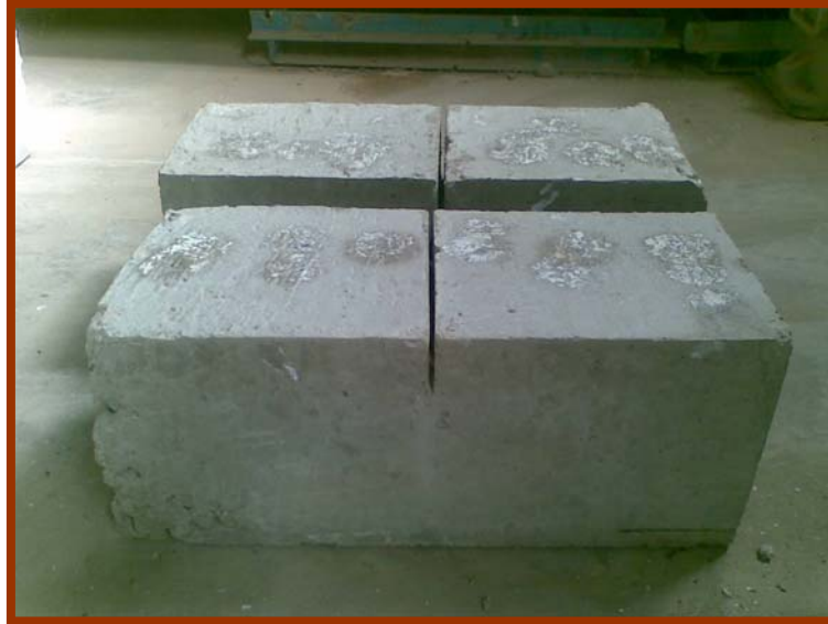
شكل رقم (4) النماذج المستخدمة لإيجاد عمق الشق
