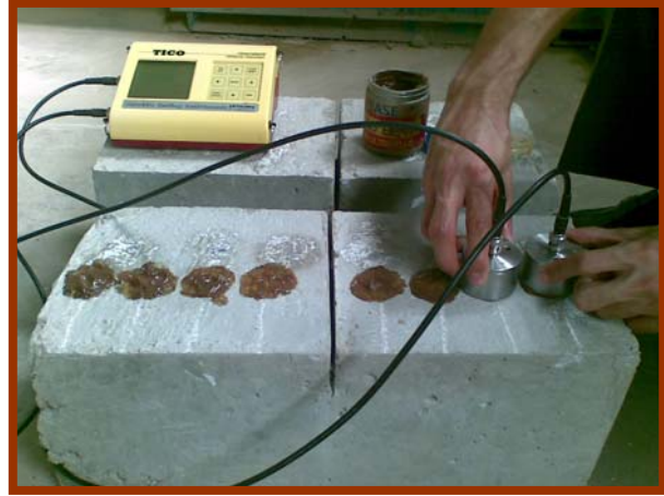
شكل رقم (6) فحص الموجات فوق الصوتية لإيجاد عمق الشق
