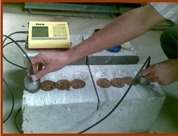
شكل رقم (6) فحص الموجات فوق الصوتية لإيجاد عمق الشق
